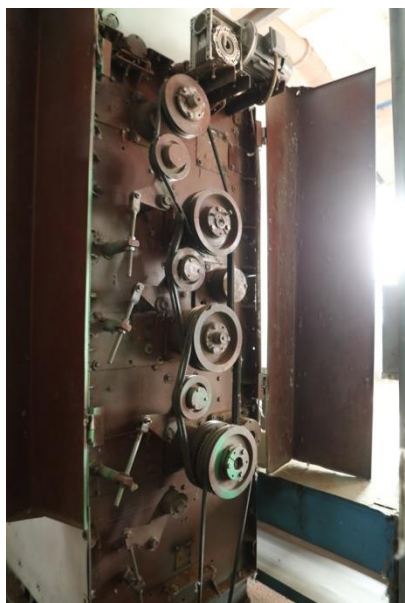
а – общий вид привода очистителя ПТ-10
