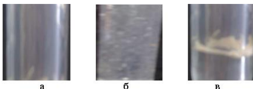
Рис.2. Фотографии, изображающие фазового превращения смеси Na-КМЦ:ХЗ (85:15) в зазоре коаксиальных цилиндров: а – \omega \approx 0 ; б – \omega \approx 180 об/мин, t \approx 5 мин; в – \omega \approx 10 об/мин, t \approx 10 мин.
